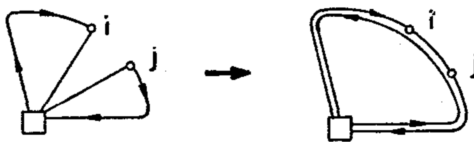
14. ábra. Szimpla hurok és csillag egyesítése dupla hurokká
