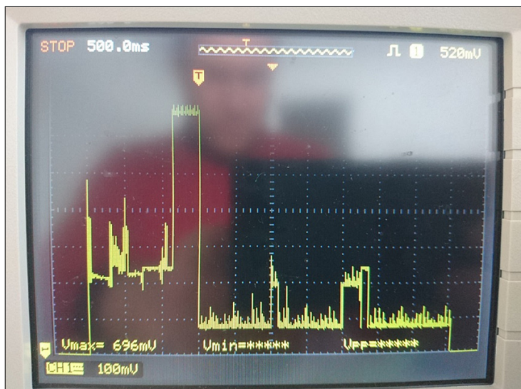
8. ábra A LoRa modul áramfelvétele (feszültség egy 10 Ohm-os sorosan kötött ellenálláson)
