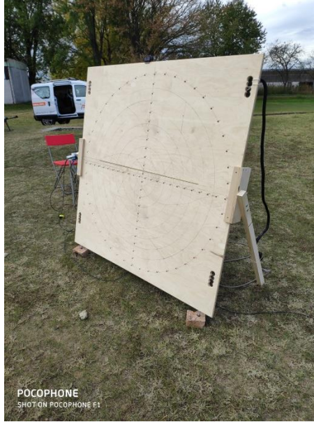
24. ábra: A mérésekhez felhasznált 48 csatornás mikrofontömb, az állvány tetején elhelyezett webkamerával.
