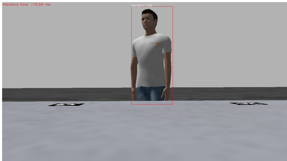
5.3. ábra: YOLOv4 futásának ideje GPU nélkül
