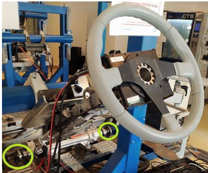
8. ábra Rögzített fogasléc a mérőpadon
