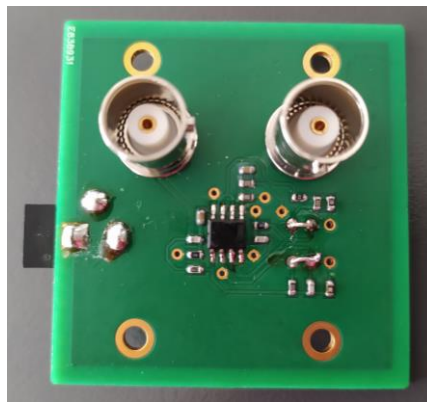
25. ábra: Feszültség átalakító panel
