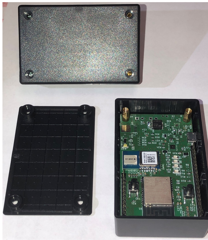
2.24. ábra. Dobozban rögzített fejlesztői kártya zárt tetővel, illetve nyitott tetővel
