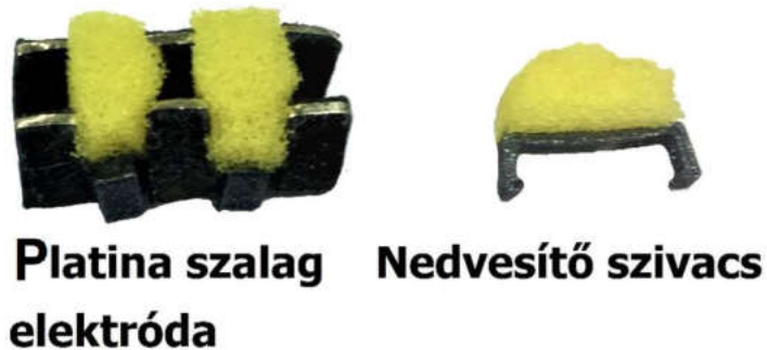
16. ábra: Nedvesítő szivaccsal ellátott elektróda.
