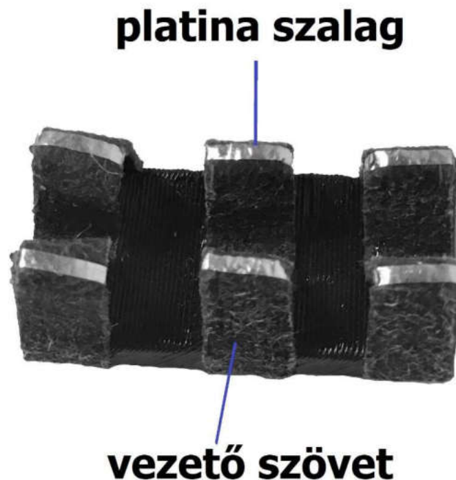
15. ábra: Gyártási időre optimalizált elektróda
