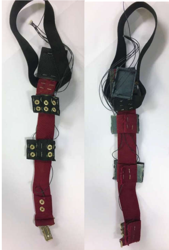
40. ábra: Rugalmas P300 fejpánt. Három darab állítható lecsatolható elektróda tartóval.
