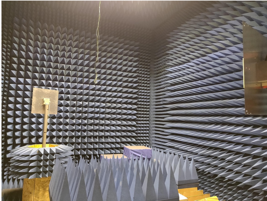
8.1. ábra. Az antenna iránykarakterisztikájának mérési elrendezése. A távolabbi antennát forgattuk, mely egyben az adóantenna is volt
