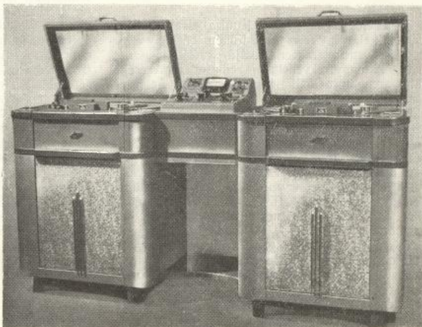
2. ábra. Szovjet RMSh-16 típusú stúdiómagetofon.
