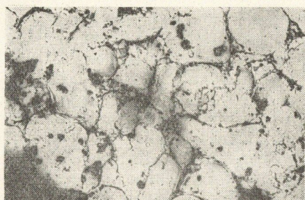
4. ábra. Elektronmikroszkópos felvételek és „Talysurf” diagrammok különböző korundokról. Az elektronmikroszkópos felvételeken látható fekete foltok pórusok. Nagyítás: 2500\times A „Talysurf” görbék a mellettük levő elektronmikroszkópos felvételeken látható felület-érdességét mutatják. Amplitúdó nagyítás: 2000\times , hossznyagítás: 100\times
