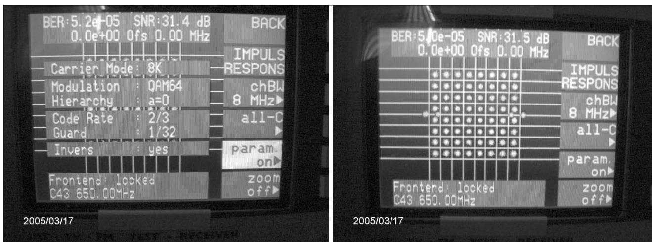
14. ábra Az MSK 33 mérővevő munkaablakai az adásmód és a konstellációs ábra megjelenítésére
