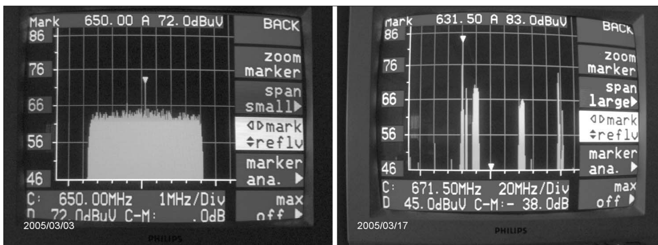
15. ábra Spektrumanalízis az MSK 33 mérővevővel.
