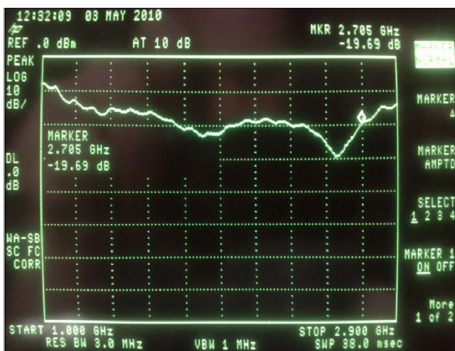
8. ábra Non-uniform illesztő bemeneti reflexiója
