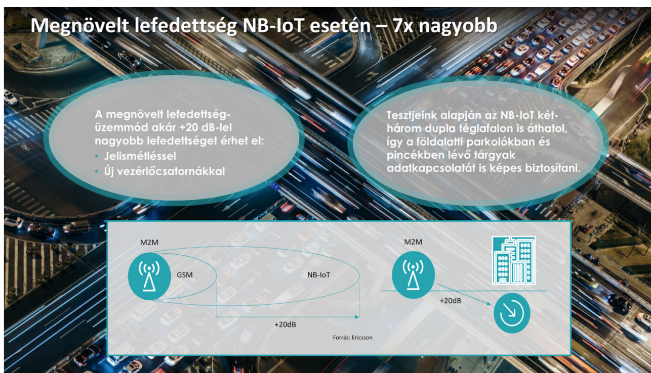
1. ábra – Az NB-IoT esetén elérhető megnövelt lefedettség: az extended coverage mód akár +20 dB teljesítmény mérleg (link-budget) javulást is eredményezhet a GSM-hez viszonyítva, jelentősen növelve a cellák hatósugarát (Forrás: Ericsson).
