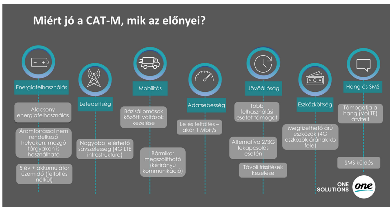
3. ábra – A CAT-M (LTE-M) technológia főbb előnyei és képességei: alacsony energiafelhasználás (elemes eszközök több éves üzemidővel), kiterjedt lefedettség a 4G infrastruktúrán, mobilitás támogatása (cellaváltás mozgó eszközöknél), megnövelt adatsebesség (akár ~1 Mbit/s), jövőállóság (széles körű IoT eszköztámogatás, 2G/3G kiváltás és távoli frissítések lehetősége), alacsony eszközki költség (megfizethető modulok), valamint hang- és SMS-szolgáltatások integrálhatósága (VoLTE alapú hangátvitel).
