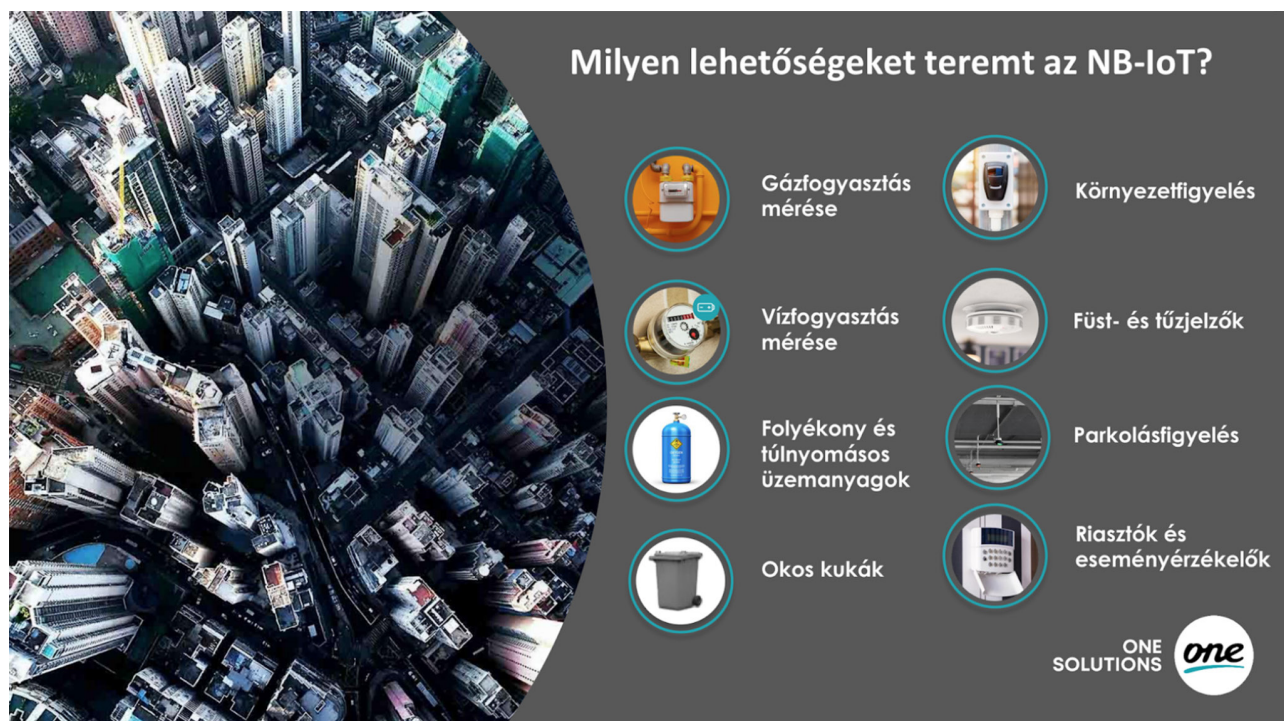
2. ábra – Az NB-IoT technológia tipikus alkalmazási területei: példák között a közművek távmérése (gáz, vízfogyasztás), folyékony vagy túlnyomásos anyagok tartálszint-mérése, okos hulladékgyűjtők telítettségfigyelése, környezetmonitoring szenzorok, füst- és tűzjelzők hálózata, parkolóhely-érzékelők, valamint riasztó- és eseményérzékelő berendezések távfelügyelete.
